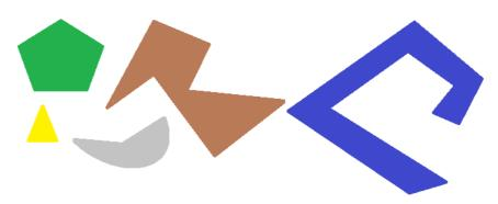
无疑,按类型放置具有 90° 步进旋转并占据更小更紧凑区域的单个形状的问题并不简单:每个形状具有 4 种可能放置求解 (0°、90°、180°、270°),必须为其余图的每个可能放置和每种可能配对组合求解。
