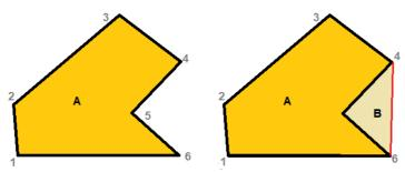
不使用凹形区域将加速计算过程,降低材料使用效率。
