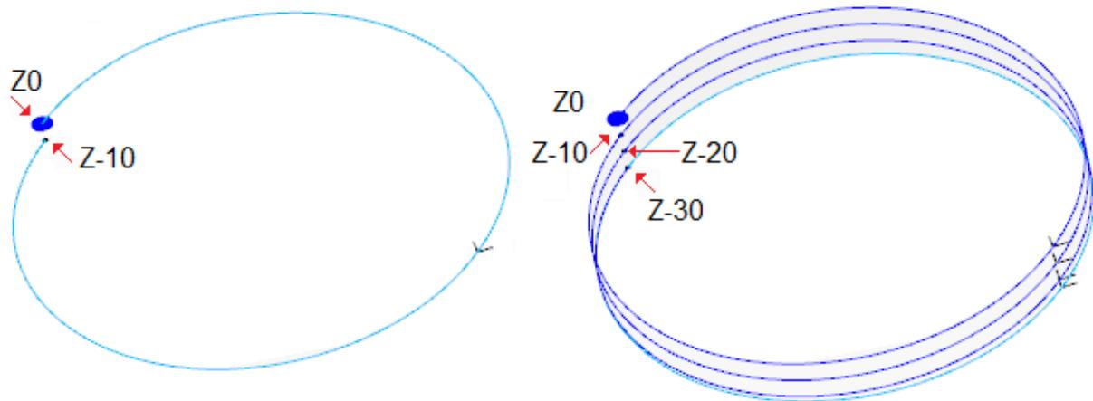
左侧：显示分配有一个以Z深度从0.0到-10.0执行的圆的原始外形。
