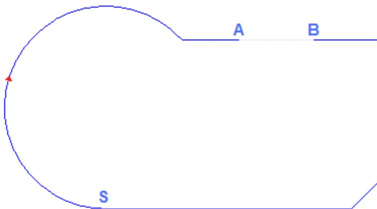
外形上标出了2个切割点：即 (A) 和 (B)，两点可在相同外形段上，也可在不同外形段上。两点之前的外形部分会被删除 (警告：方向为原始外形的方向)。
