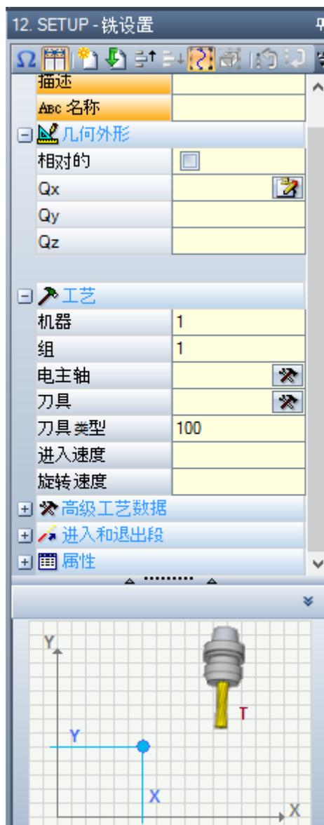
在窗口列表中，首先选定列表中将指定的设置编码（在图中：[SETUP] 铣设置），而且参数列表利用选定的加工数据进行更新。然后，设定工艺参数和工作属性，并按[确认]键确认应用赋值。
