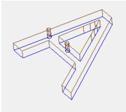
图示是一个3D视图，整体尺寸视图被启用：每个外形段突出片段中工具的整体尺寸。默认设置为禁用。通过视图菜单中 3D 图形的输入状态整体尺寸调节选项应用。可从本地菜单更改选择的值，并在视图菜单 3D 图形中的整体视图上进行管理。若使用定位设置对外形进行编程，设置由一个圆柱显示，该圆柱为定向绘制，而且相关外形依据设置程序的配置参数利用定向段进行显示。
