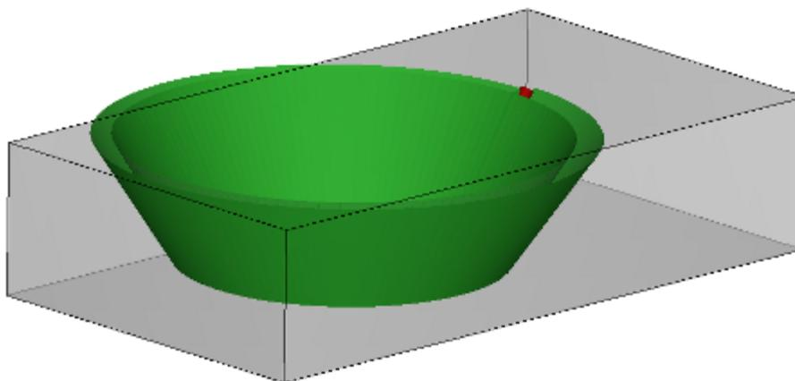
如果切线跟踪选项确认刀具方向与面垂直，同样对应在执行外形时保持刀具轴垂直的要求，即使面平面发生变化并符合以下垂直设置案例构造。
