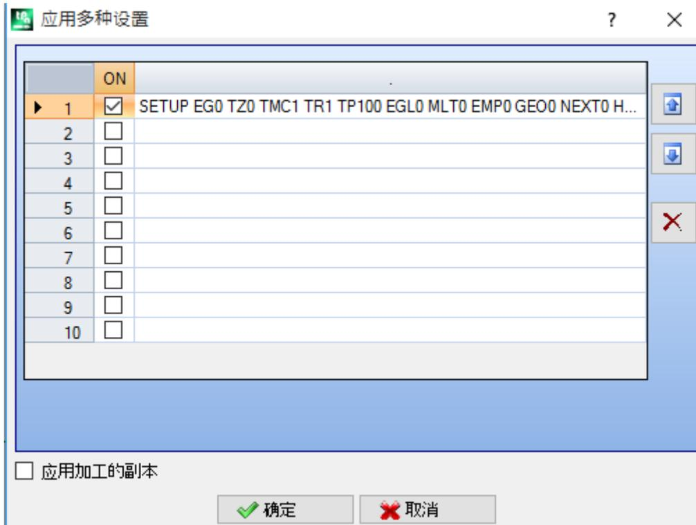
窗口显示了一个10行的表格。每行可指定一个设置，具有相同的设置，作为单独设置应用。要启用一个设置，在ON列选择相应的框：选择窗口打开（加工设置，工艺）；修改已设定的设置：双击（或按F2键）相关的右侧，打开赋值窗口；要禁用已指定的设置：去掉ON列相应框的选择。
