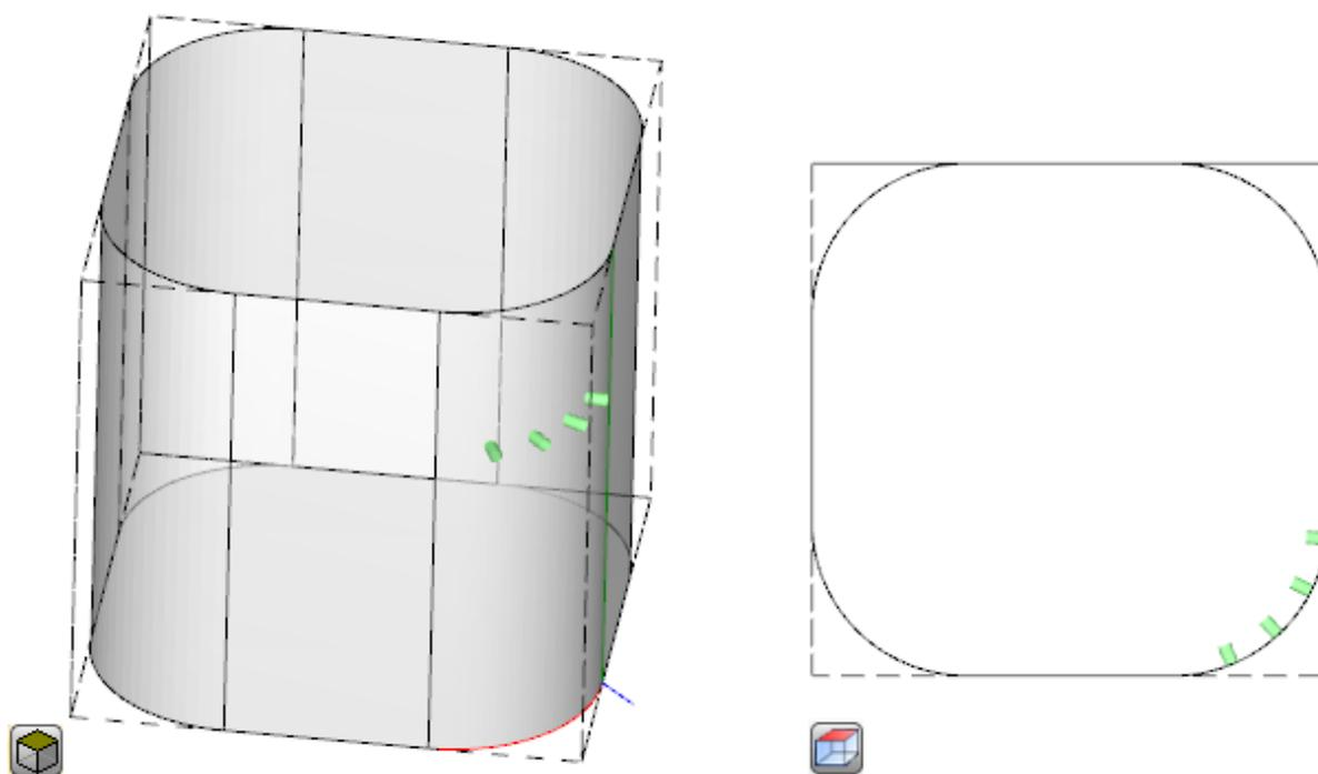
编程有方向的设置可以启用切线跟踪模式，对应在执行外形时保持轴垂直的要求。此模式用于执行一些非垂直铣削（刀具轴与 XY 面平面或倾斜平面平行，但不与 XY 平面垂直），需要保持刀具旋转轴与要执行的外形垂直。
