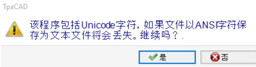
上图的提示信息显示，Unicode 字符仅用于辅助设置，如程序、变量和过程说明。辅助设置记录时出现的信息丢失现象会更改文本的图形显示，但不会更改对程序的解读。
