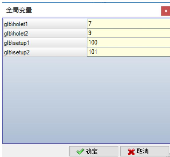
此表可以显示多达 300 个数字变量，可以通过符号名称调用，具有下列格式：“glb\xxx”，“xxx”= 符号名称。变量依据 TpaCAD 配置指定，而且可以用于每个设置值。
