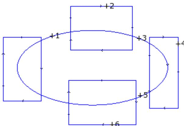
图中显示了由交叉外形构成的一个程序。6 处相交确定了构建一个新外形的指定部分。交叉要编号，指出了选定部分添加到新外形的顺序：
