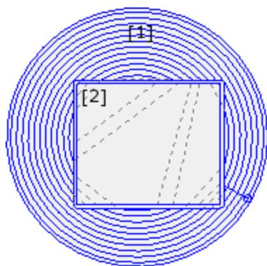
在图形中：带有矩形孤立体 (2) 的圆 (1) 的挖空过程。
