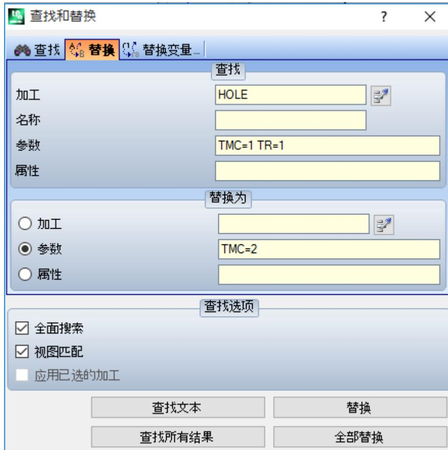
在第二个图形中显示的设置值需要替换操作代码。G89加工是将用G88加工替换的，无其他设置但会由被称为G88的加工替换。
