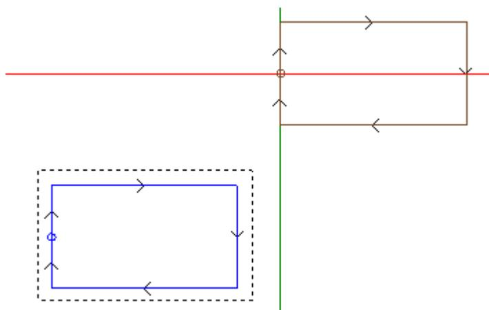
图形中选定的矩形表示子程序延伸（一个矩形交叉顺时针，初始点定位在左侧垂直边中部）。
