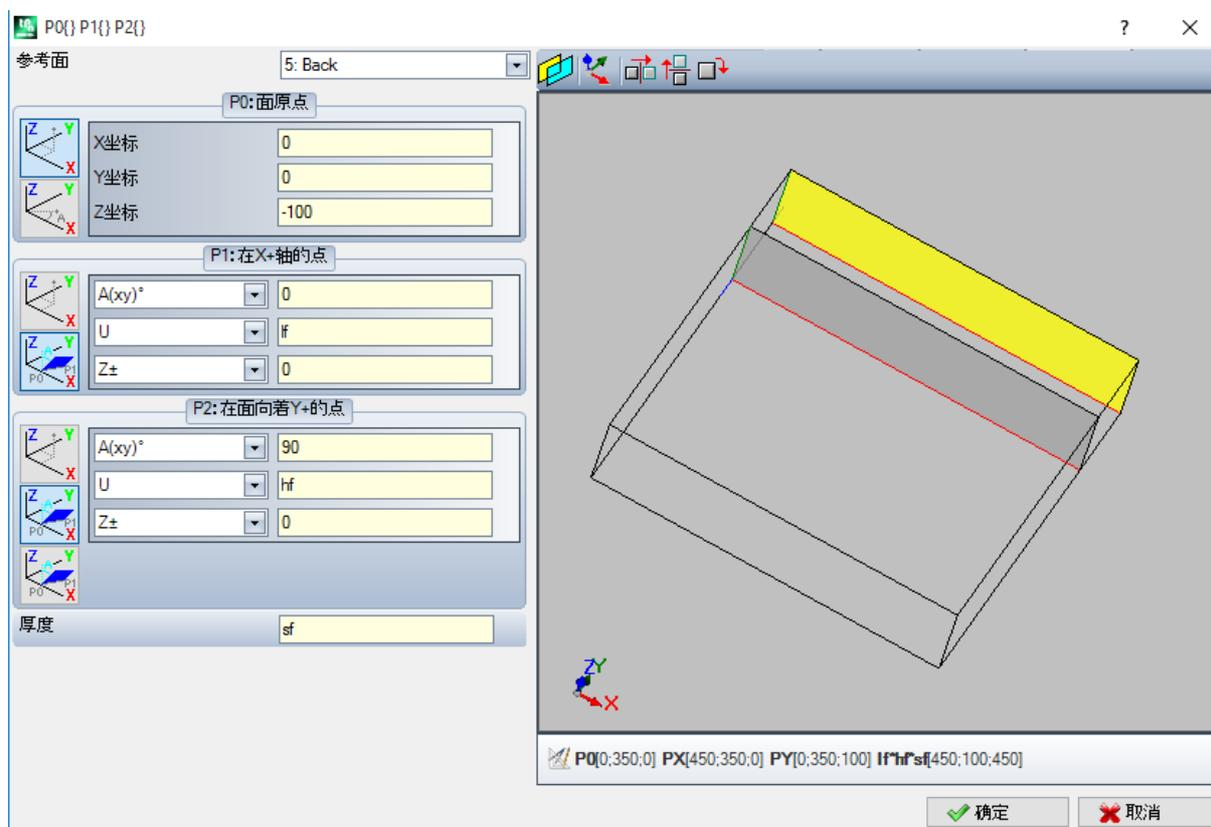
参考面: 面5: 按下
